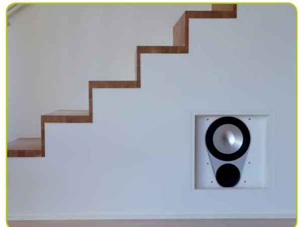
Hinter dem weißen, magnetisch gehaltenen Gitter verbirgt sich ein 25-cm-Aktiv-Subwoofer
